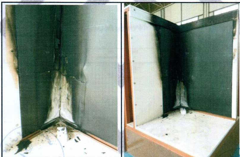
شکل ۴- آزمون عایق الاستومری Parto-Flex، خارج از محیط آزمون
