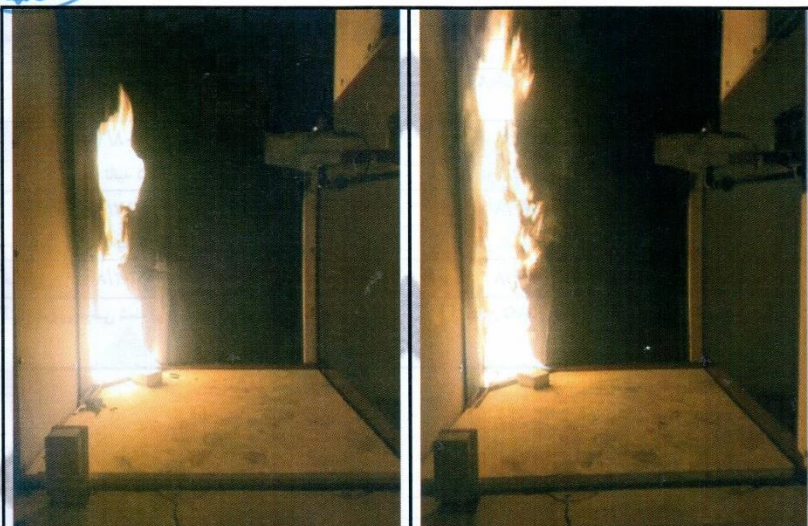
شکل ۳- آزمون عایق الاستومری Parto-Flex، حین آزمون SBI
